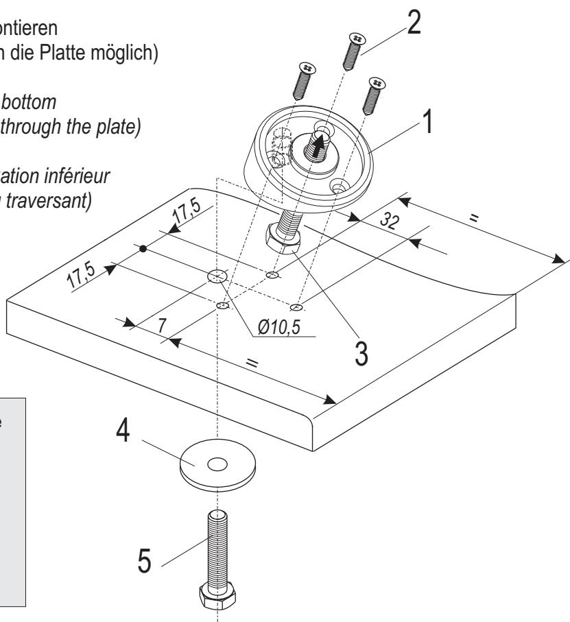
Falls die Befestigung durch die Arbeitsplatte bauseitig nicht möglich ist , entfallen die Positionen 4 + 5
