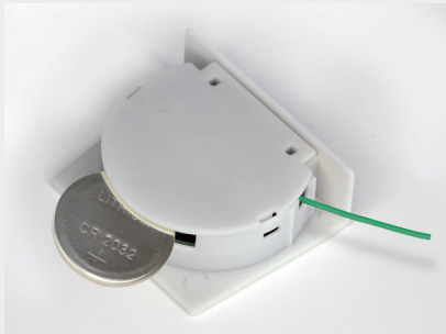
Die Batterie lässt sich mit Hilfe eines dünnen Drahtes (z.B. Büroklammer) heraus drücken.
